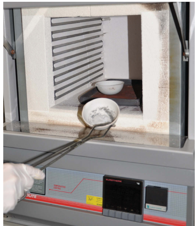
Abbildung 7: Probe nach Veraschung im Muffelofen
