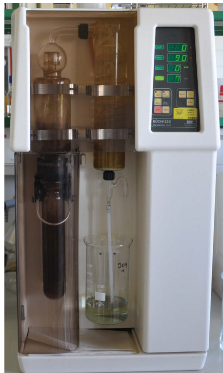
Abbildung 5: Destillation der Probe am Beginn (links, Indikator ist violett) und am Ende der Destillation (rechts, Indikator ist grün)
