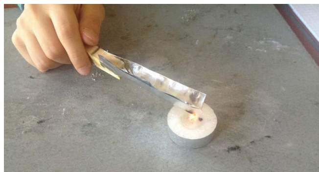
Abbildung 3: Hitzetest für ein weißes Pulver
