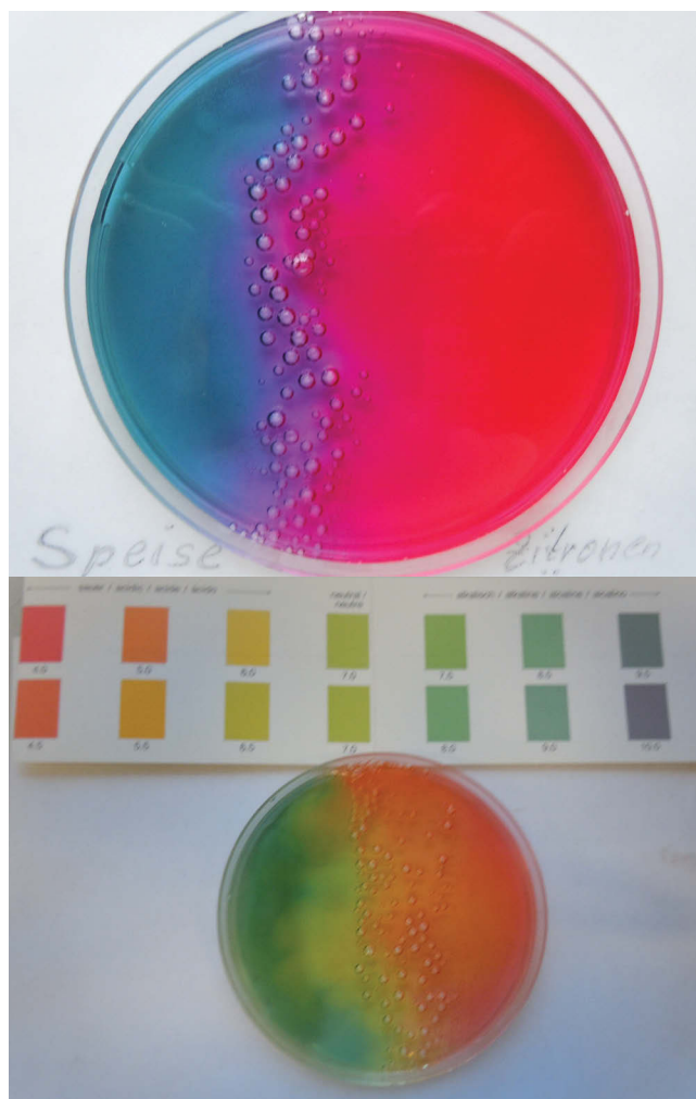
Abbildung 4 (oben): Reaktion von Speisnatron (links) und Zitronensäure (rechts) in Rotkrautlösung
