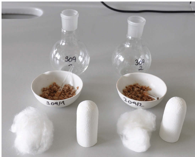
Abbildung 3: Die getrocknete Probe (Mitte), Extraktionshülsen (unten), Kolben für Ether
