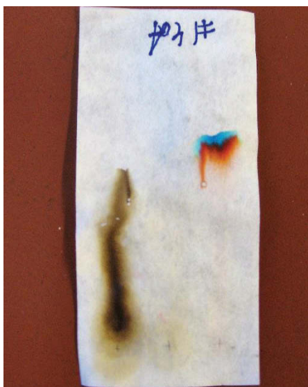
Abbildung 6: Papierchromatogramm: Cola (links), Filzstift (rechts)
