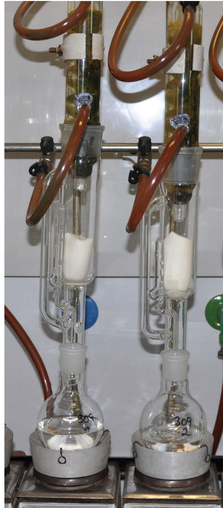
Abbildung 4: Extraktionsapparatur nach SOXHLET
