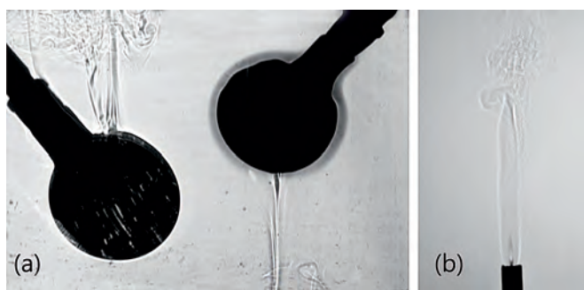
Abb. 5: Konvektion sichtbar gemacht durch Schattenprojektion mit einer Halogenlampe ohne Kondensor. Links: Zwei Glaskolben mit heißem bzw. kaltem Wasser. Rechts: Konvektion in Luft oberhalb einer Kerze.
