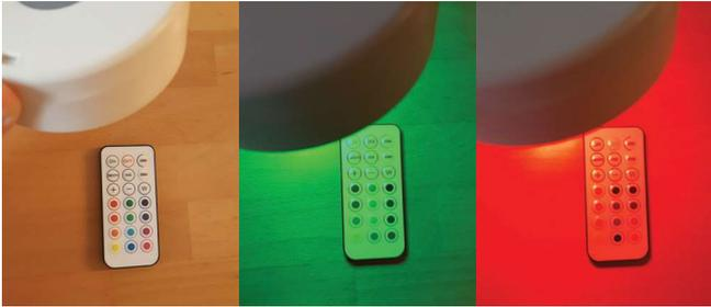
**Abbildung 1:** Die Fernbedienung der batteriebetriebenen LED-Leuchte wird durch weißes, grünes und rotes Licht beleuchtet. Es zeigen sich unterschiedliche Farbeindrücke.
