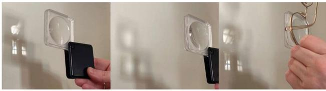
**Abbildung 2:** Ein scharfes Bild wird durch Vergrößerung des Abstands zwischen Linse und Wand („Kurzsichtigkeit“) unscharf. Mit Hilfe einer Brille kann dieser Sehfehler korrigiert werden.
