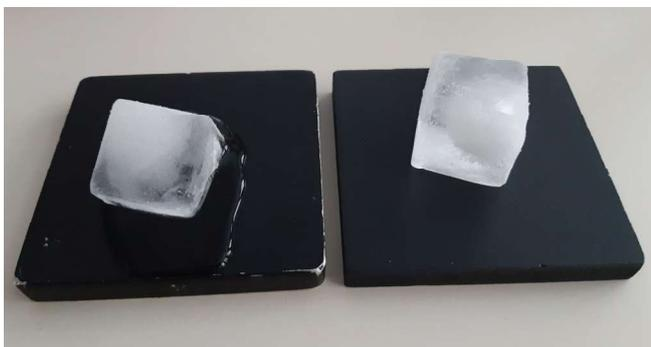
**Abbildung 5:** Eisschmelzplatten – die linke Platte besteht aus einem Material mit guter Wärmeleitfähigkeit, sodass der Eiswürfel rasch durch die aus der Umgebung zugeführte Energie schmilzt.
