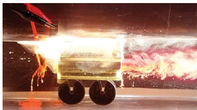
Abbildung 1: Die magnetohydrodynamische Pumpe in Betrieb
