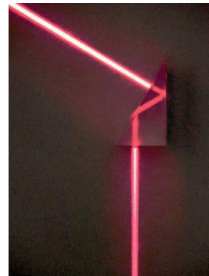
Abbildung 6: Strahlenverlauf mit einer Lasermäus-Wasserwaage
