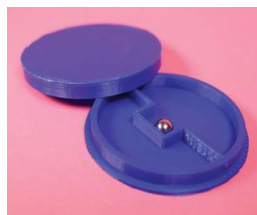
Abbildung 2: Innere Struktur einer 3D-druckbaren Blackbox mit einer Stahlkugel.
