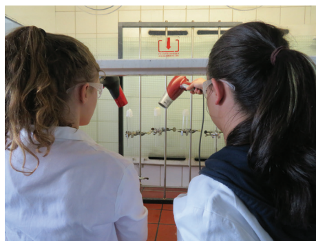
Abbildung 8. Montage des Textilstrumpfs und Trocknung.
