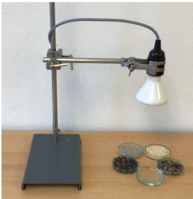
**Abbildung 4:** Absorption von Wärmestrahlung durch unterschiedliche Oberflächen. Der gleiche Versuchsaufbau kann ebenfalls genutzt werden, um die Absorption von sichtbarem Licht durch verschiedene Oberflächen zu untersuchen, die resultierenden Temperaturänderungen fallen jedoch wesentlich geringer aus.
