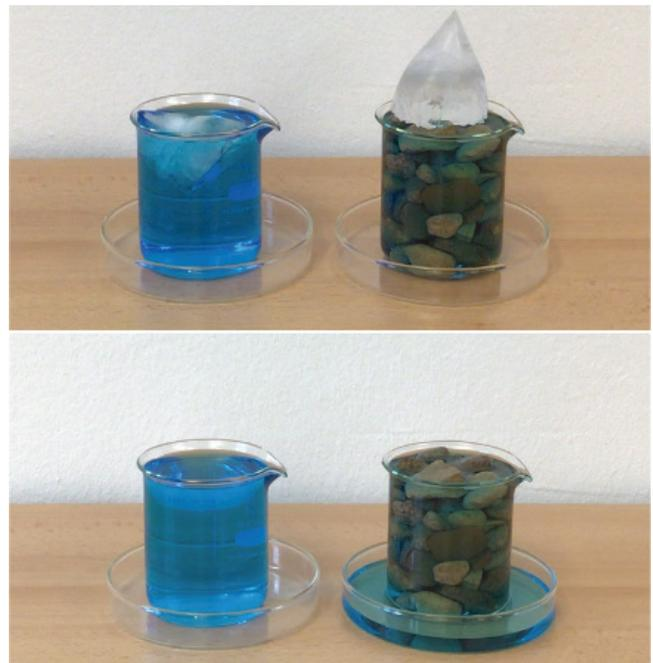
**Abbildung 8:** Folgen des Klimawandels: Einfluss des Eisschmelzens auf den Meeresspiegel und Eis-Albedo-Rückkopplung, die unter dem Eis liegenden Oberschichten werden dem Sonnenlicht ausgesetzt (vgl. Abschnitt 1.2).
