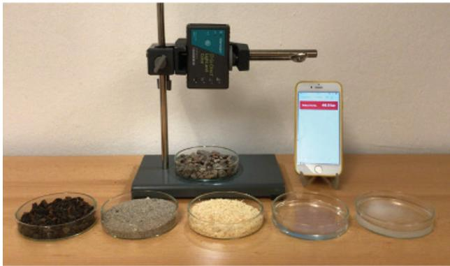
**Abbildung 2:** Analyse der Albedo für verschiedene Oberflächen mit dem Vernier GO DIRECT Farb- und Lichtsensor.
