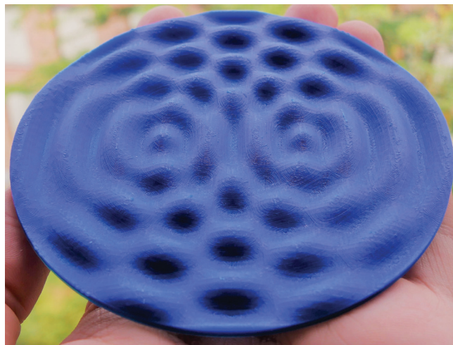
Abbildung 6: Überlagerung zweier Elementarwellen 3D-gedruckt mit dem Ultimaker 3.
