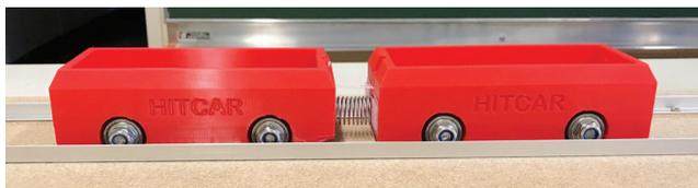
**Abbildung 4:** Die beiden Hitcars sind mit einem Faden verbunden. Wird der Faden durchgebrannt, so werden die beiden Wägen durch die Feder beschleunigt.
