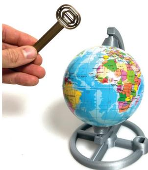
**Abbildung 1:** Experiment mit Magnetfeldsonde an einem Modell des Erdmagnetfeldes. Im Inneren der Schaumstoffkugel befindet sich ein langer Neodymmagnet (mehr zum Experiment in [5], Bauanleitung unter [3])
