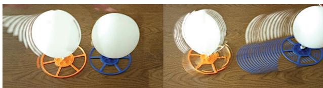
**Abbildung 3:** Bewegung zweier Gleiter bei Stoßversuchen: vor dem Stoß (links) und nach dem Stoß (rechts), Stroboskopaufnahme wurde mit MotionShot erstellt.
