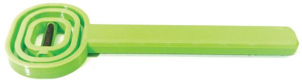
**Abbildung 9:** Fertige Magnetfeldsonde mit eingesetztem Magneten.
