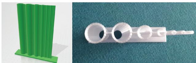
**Abbildung 1:** Oberteil des Apparats. Zwischen die Steigrohre wurden stabilisierende Zwischenwände eingefügt.
