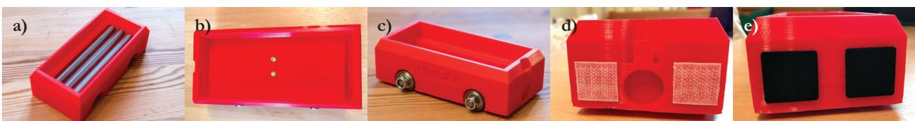
Abbildung 2: Zusammenbau des Hitcars
