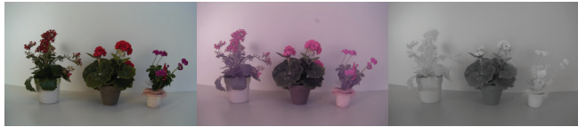
Abbildung 7: Echte Pflanzen im Vergleich zu einer Kunstblume aufgenommen mit einer Kamera mit IR-Sperrfilter (links), ohne jegliche Filter (Mitte) und mit der selbstgebaute NIR-Kamera (rechts). Die Blätter von gesunden Pflanzen reflektieren nahes Infrarot stark und erscheinen daher schneeweiß.
