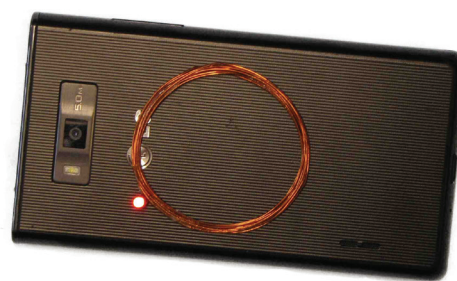
Abb. 10: Spule mit LED für 13,56 MHz an der Rückseite eines Smartphones mit NFC-Funktion
