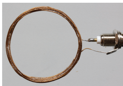
Abb. 4: Spule mit Anschluss für das USB-Oszilloskop
