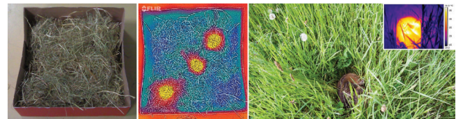
Abbildung 10: Drei wenige Zentimeter große Kunststofftierchen wurden im Wasserbad erhitzt und im Heu versteckt (links). Im thermalen Infrarotbild werden ihre Verstecke schnell erkannt (Mitte). Die Technik wird bereits erfolgreich zur Rettung von Wildtieren eingesetzt (rechts Bild: DLR).
