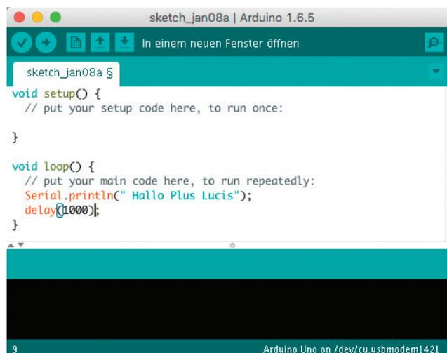
Abbildung 1: Die Arduino GUI mit einfachem Sketch
