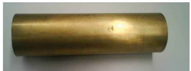
**Abbildung 7:** 20 cm langer massiver Messingzylinder mit einem Durchmesser von 6 cm, der in der Sand-Kies-Schichtung vergraben wird (Foto: Nathalie Schneider).
