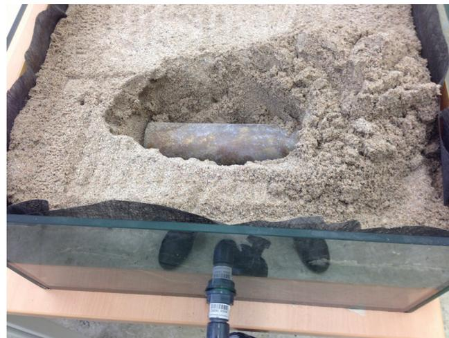
**Abbildung 8:** Versuchsaufbau mit dem vergrabenen Messingzylinder (Foto: Ellen Gottschämmer).
