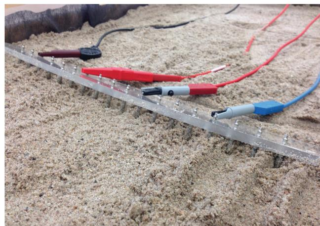
**Abbildung 9:** Plexiglasrechen, der mit 19 Bananensteckern bestückt ist. Diese werden für die Versuchsdurchführung in den Sand gesteckt. Jeweils vier Bananenstecker werden als Sonden verwendet und mit Kabeln verbunden (Foto: Ellen Gottschämmer).
