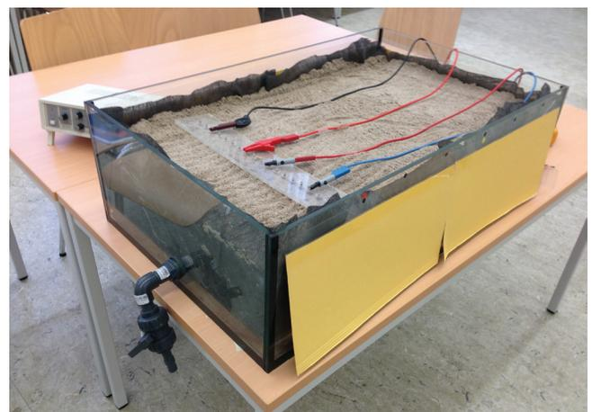
**Abbildung 6:** Versuchsaufbau in einem Glaskasten. Die Seitenwände sind mit Pappe verdeckt, um den Blick auf die Schichtung zu verdecken. Am linken Bildrand erkennt man den Abfluss im Glaskasten. Auf der sandigen Oberfläche liegt ein Plexiglaslineal, an dem als Elektroden Bananenstecker befestigt sind (Foto: Ellen Gottschämmer).
