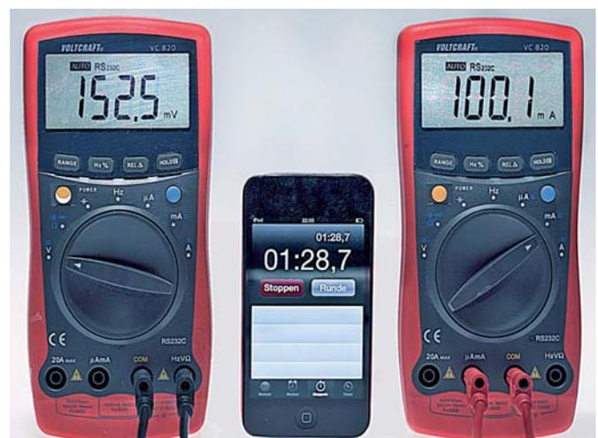
Abb. 9: Messwert-Dokumentation – Anordnung für Videodokumentation der Messwerte
