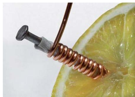
Abb. 5: Verzinkter Drahtstift mit Filterpapier und Kupferdraht
