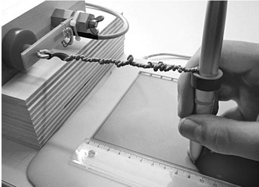
Bild 1: Kraft-Dehnungsmessung an einem verdrehten Gummiband mit Low-Cost-Komponenten (Grafiktablett und Dehnungsmessstreifen).
