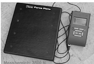
Eine genauere Analyse des Kraftverlaufs wird durch die Verwendung einer Kraftmessplatte [7] ermöglicht. An das Messinterface ULAB wird eine Kraftmessplatte angeschlossen.
