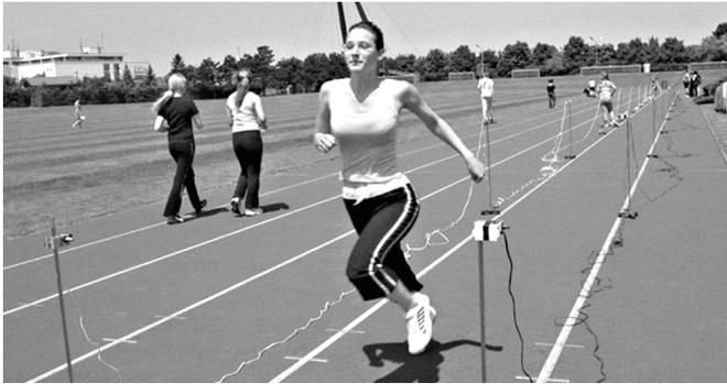
Die 60-m-Laufstrecke wurde in zehn gleich lange Abschnitte unterteilt, mit Hilfe von zehn Lichtschranken wurden die Durchgangszeiten ermittelt. Dazu diente eine eigens angefertigte Lowcost-Lichtschrankenkette [4].
