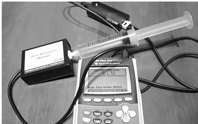
Mit dem Drucksensor kann die Abhängigkeit des Drucks vom Volumen für eine bestimmte Gasmenge untersucht werden. Der Messbereich des Vernier Drucksensors beträgt 0 bis 210 kPa.
