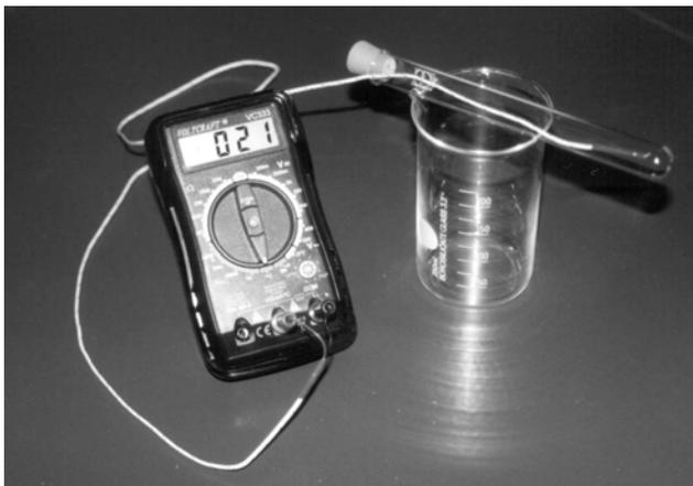
Die Kältemischung besteht aus einer Wasser-Eis-Mischung im Becherglas, zu welcher man einige Löffel voll NaCl oder  $\text{NH}_4\text{Cl}$  dazugibt und gut umrührt. In der Kältemischung stellt sich eine Temperatur von -10 bis -15 °C ein!
