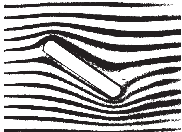
Abb. 12: Zirkulationsfreie Umströmung eines angestellten Bretts, aufgenommen mit der Velourpapier-Methode.
