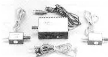
Gemessen können Stromstärken und Spannungen in Gleich- und Wechselstromkreisen werden. Das System besteht aus Verstärkerbox, zwei Strommeßgeräten und zwei Spannungs-
