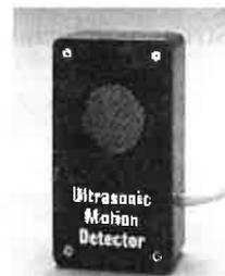
Es lassen sich Bewegungen von Personen, von Wagen auf einer Fahrbahn, eines aufspringenden Balles, von geworfenen Objekten, Pendelbewegungen, harmonische Schwingungen von Körpern an Schraubenfedern, gedämpfte Schwingungen und vieles andere untersuchen.
