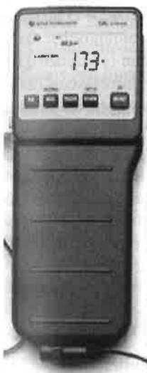
Das CBL ist ein handliches, batteriebetriebenes Gerät, das über ein Kabel mit dem Rechner verbunden wird. Über eine große Anzahl von Sensoren können Bewegungen, Temperatur, Helligkeit, Kraft, pH-Wert und vieles andere gemessen werden.
