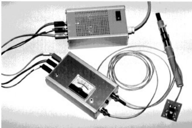
Abb. 1: Der gesamte Versuchsaufbau des Magnetometers.
