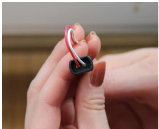
Abbildung 27, 28: Verbindung des Infrarotemitters mit dem Netzteil
