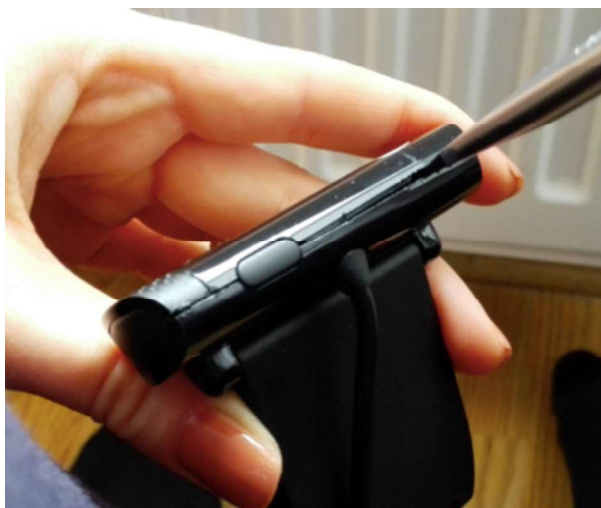
Abbildung 13: Zerlegen des Gehäuses der Webcam
