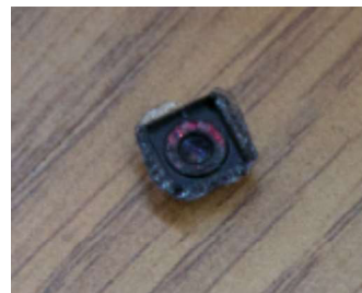
Abbildung 19: Entfernter Aufsatz ohne Infrarotfilter
