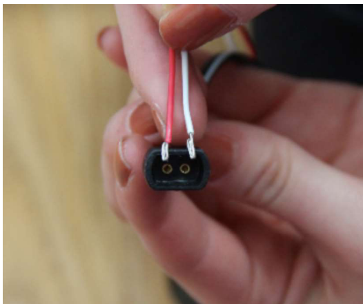
Abbildung 27, 28: Verbindung des Infrarotemitters mit dem Netzteil
