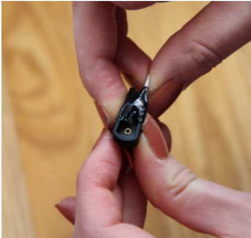
Abbildung 29: Fixierung der Kabel des Emitters durch Klebeband
