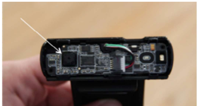
Abbildung 15: Inneres der Webcam mit Aufsatz
